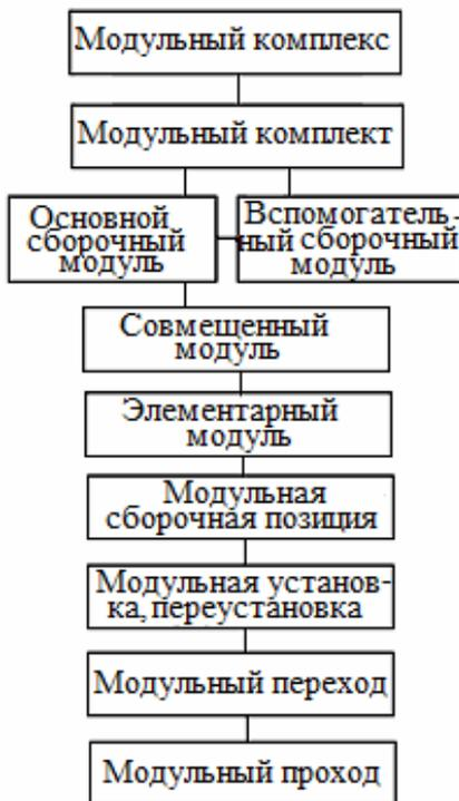
Рис. 5. Классификация сборочных модулей
